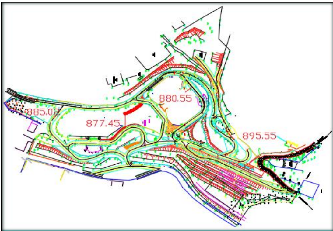
Figure II.3 : Plan topographique et voiries après terrassement.
