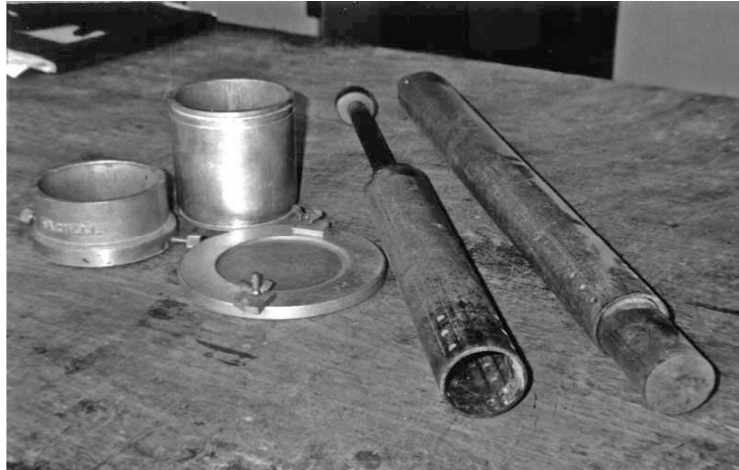
Photo I.1: Matériel pour essai de compactage Proctor (Sarsby, 2013).
