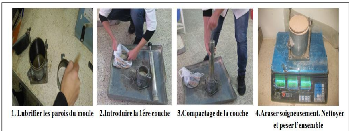
Photo III.8 : Étapes de réalisation de l'essai Proctor normal.
