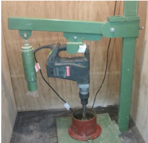
a) Compactage à marteau vibrant.
