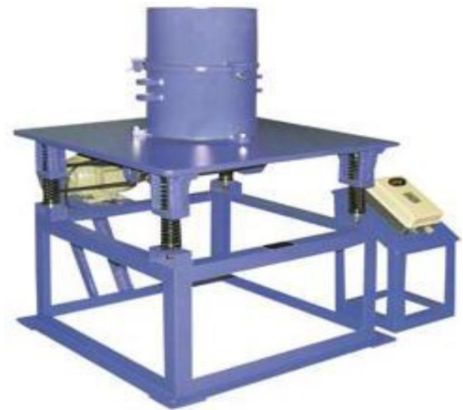
b) Compactage à table vibrante.
