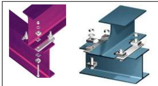
**Figure 53 :** assemblage par boulonnage
