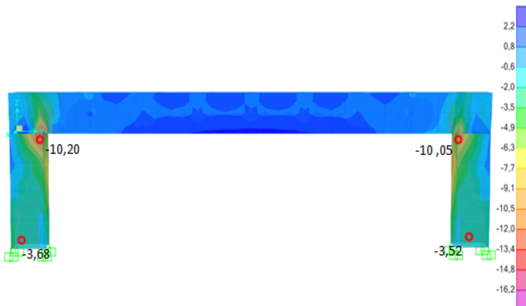
Figure 3.22 : Contraintes au niveau des poteaux principaux après enlèvement des poteaux
