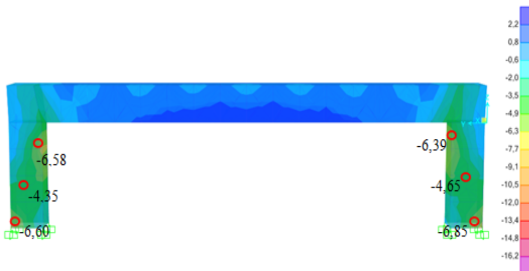
Figure 3.14 : Contraintes au niveau des poteaux principaux
