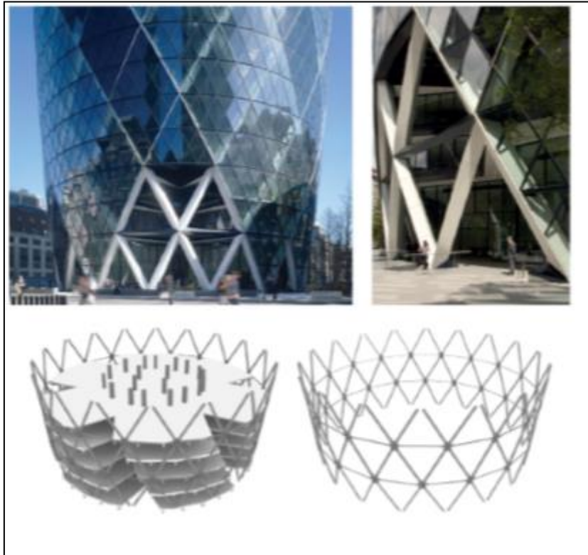
Fig.74: schéma présentatif des différents éléments constituant un système « Diagrid » 58
