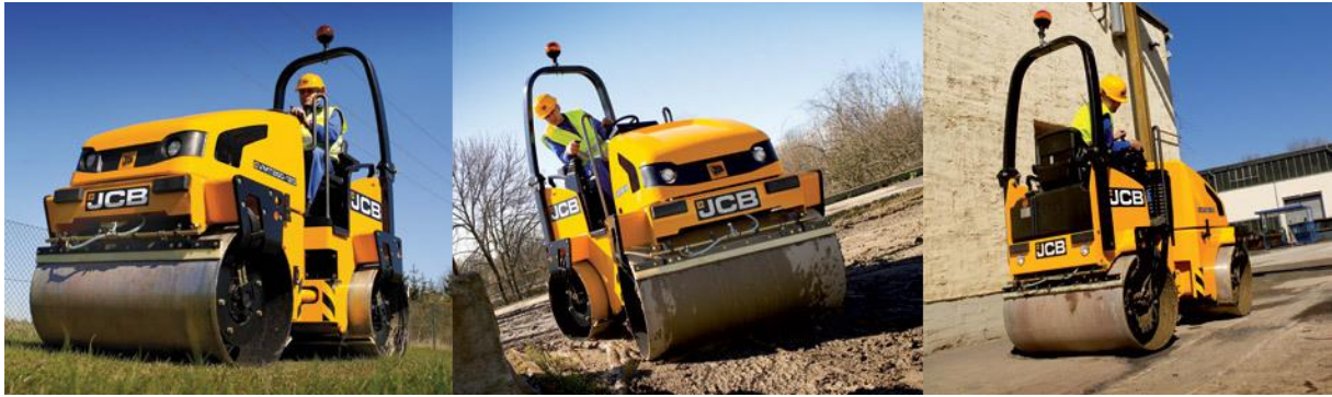
Photo II.1 : Opération du compactage statique dans différents domaines (chaussée, terrain agricole,...)
