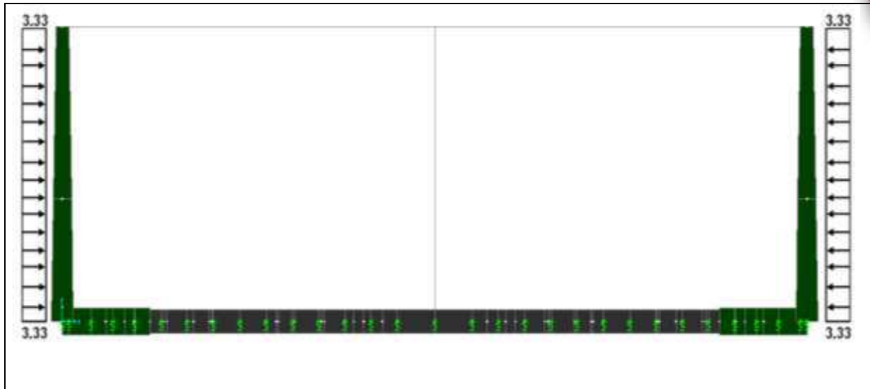
Figure 14 : Modélisation par SAP2000 des surcharges sur remblai-Partie non couverte (MDS TYPE-1) en KN/m 2
