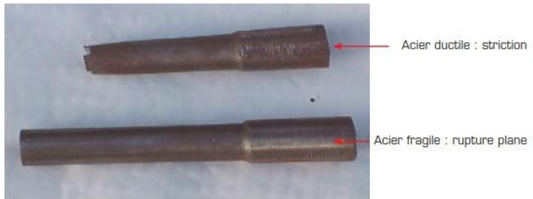
Figure IX .3 : Exemple d'essais de traction sur acier ductile et fragile
