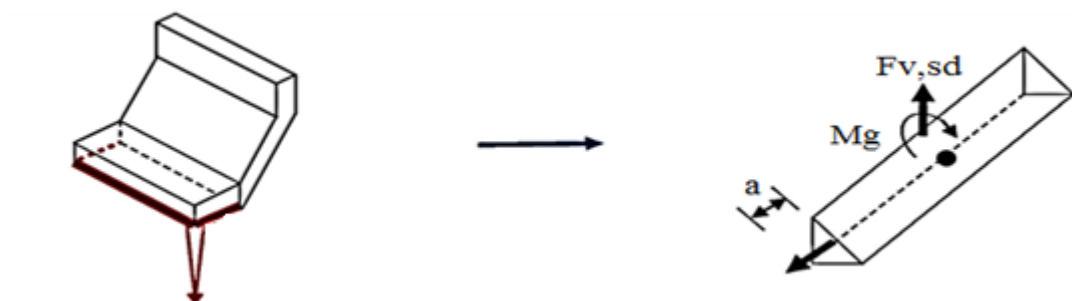
Figure III.5: Cordon de soudure de l'échantignole
