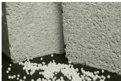
figure108 : béton cellulaire Cellumat<sup>113</sup>
