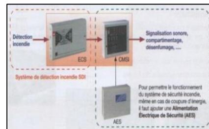
Figure 37 : Traitement de détection d’incendie <sup>42</sup>
