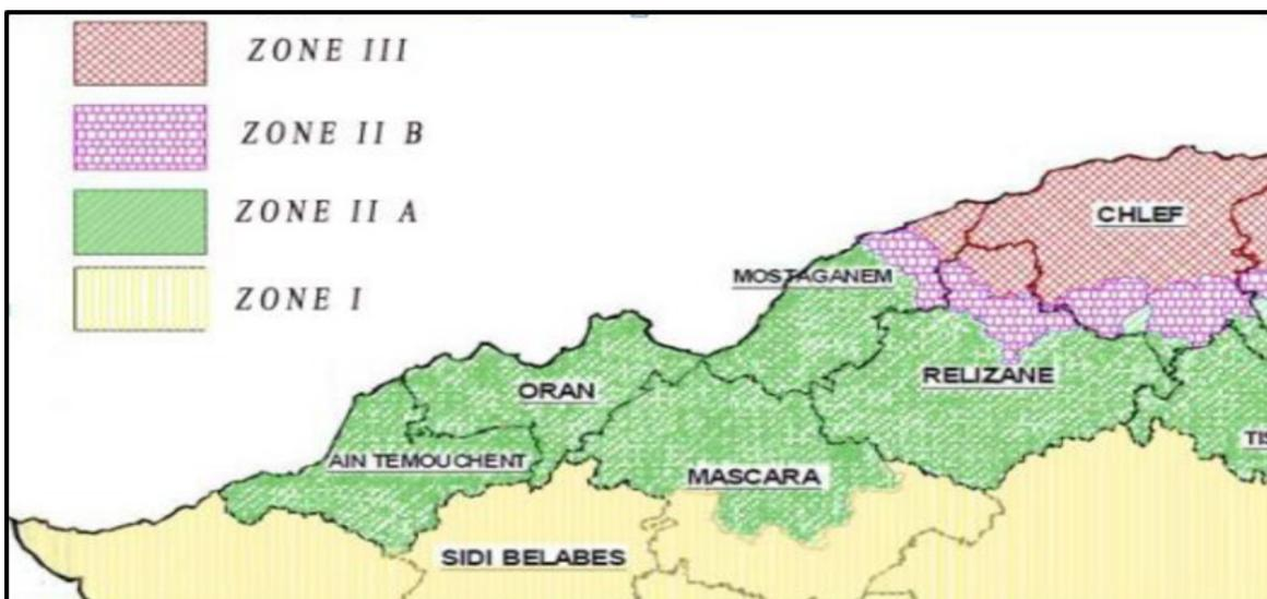
Figure (13) : une photo qui montre le classement des zones sismiques dans la région Nord-Ouest
