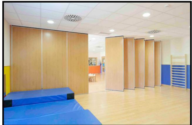
Figure (38 et 39): Cloison mobile pour les salles de sport
