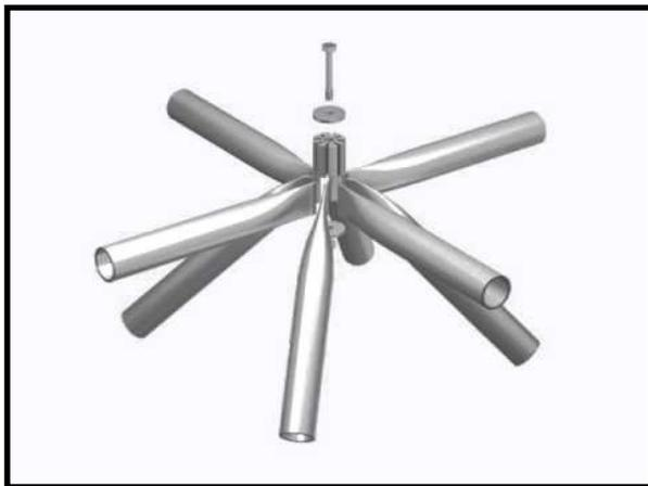
Figure (23): Assemblage de type « TRIODETIC »
