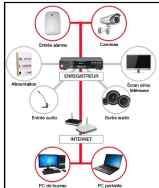
Figure (60): Système de sécurité
