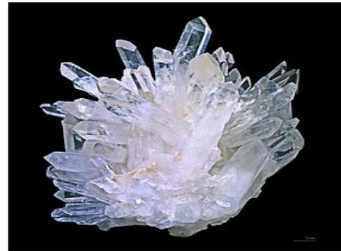
Figure (74): la matière première de la dalle piézoélectrique
