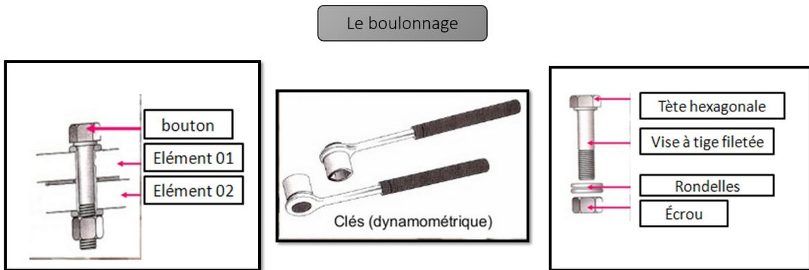
Figure (26): Photo qui montre le boulonnage
