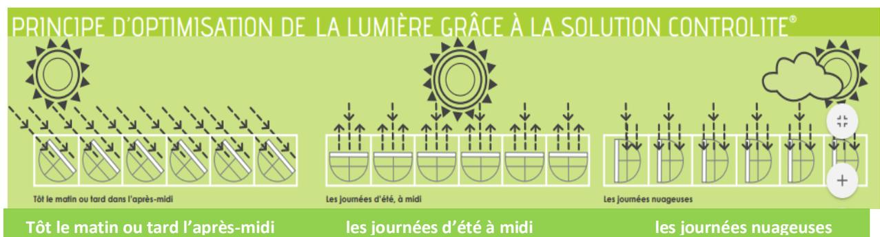
Figure 121: principe d'optimisation de la lumière grâce au système controlite
