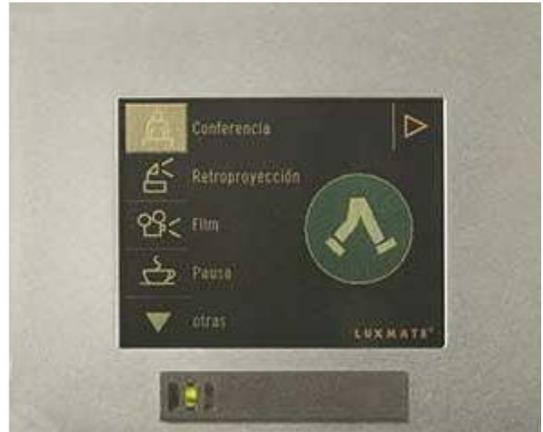
Figure168: panneau de commande avec écran tactile
