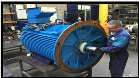
Figure 204 : Exemple d'un Moteur électrique triphasé asynchrone
