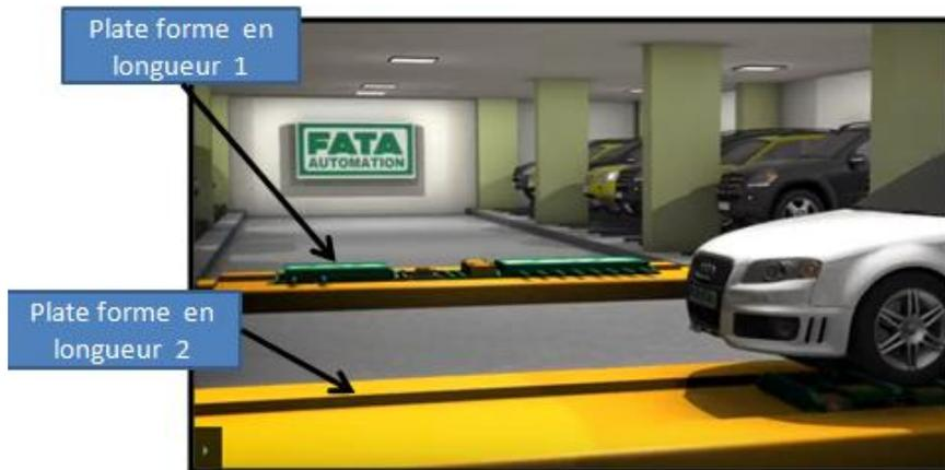
Figure 264 : Illustration des Plates formes qui déplacent le long d'un couloir central
