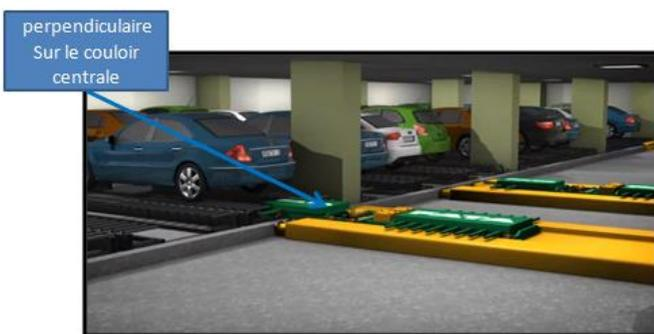
Figure 265 : Illustration des plates formes qui déplacent Perpendiculairement sur le couloir central
