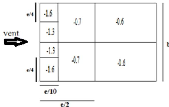
Figure II.9: Valeur de  $C_{pe}$  pour la toiture.
