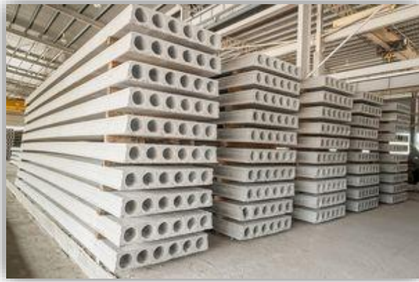
Figure 93. Photo des dalettes alvéolés à la préfabrication
