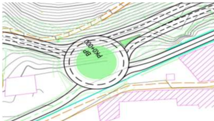
Figure 5-17: Position du giratoire de la variante 5 par rapport à la RN98.
