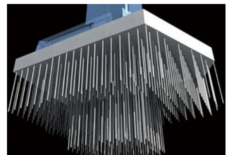
Paroi de fondations sur pieux en acier
