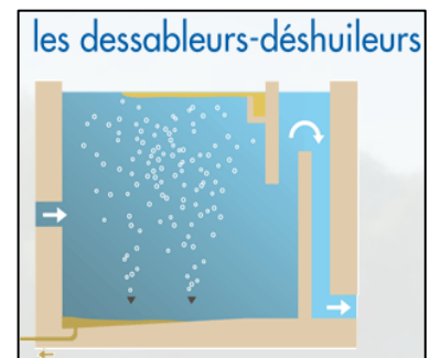
Fig.33 dessablage et déshuilage (2 ème étape de traitement d'eau)
