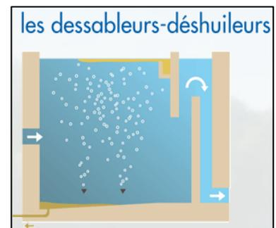
Fig.33 dessablage et déshuilage (2<sup>eme</sup> étape de traitement d'eau)
