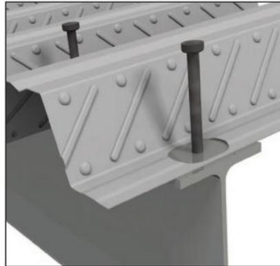
Figure IV.6. Goujons à tête soudée avec le profilé.
