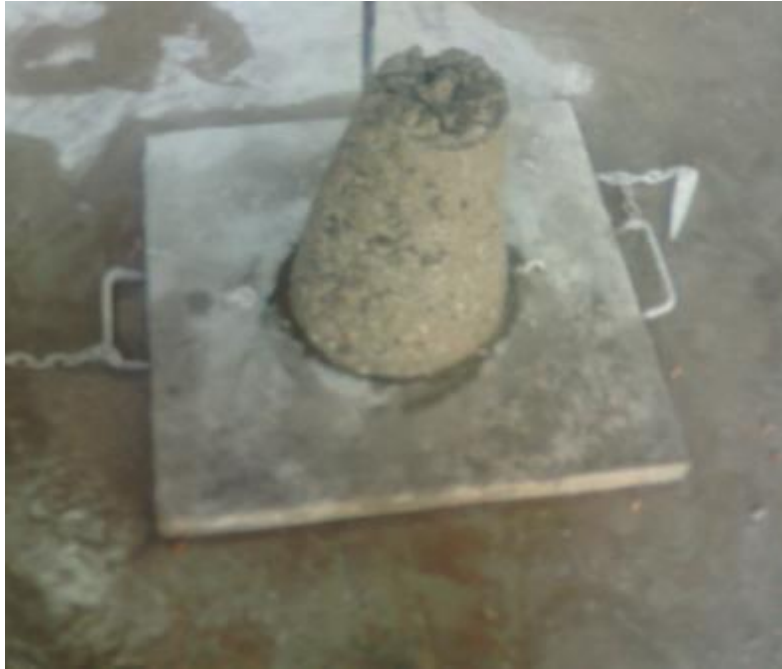
Figure 3.4: Mesure de l'affaissement du béton au cône d'Abrams (Affaissement égal à 3,5 cm)
