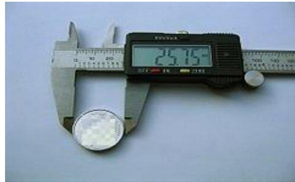
Figure 2.3: Mesure du diamètre et épaisseur
