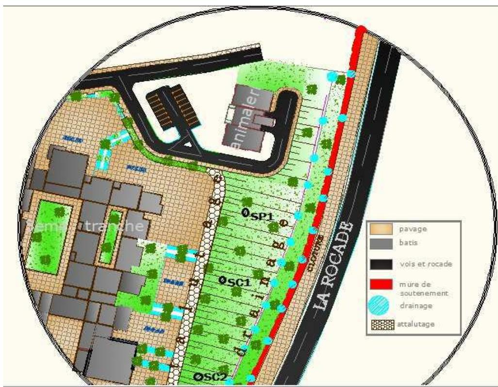
Figure IV.7 : Plan schématique d'implantation des sondages
