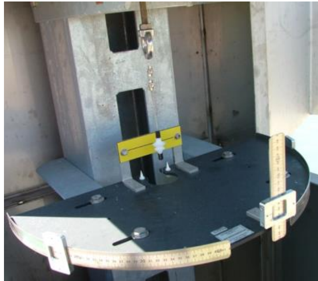
Photo III.3 : Appareil de mesure des déplacements relatifs. Pendule à table de visée avec mesure en Z
