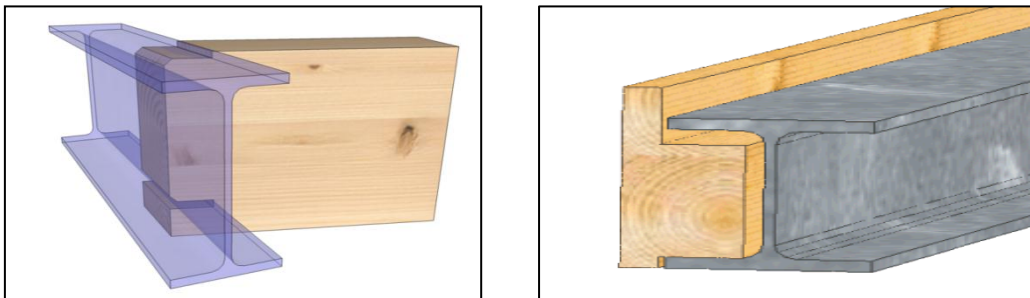
Figure 15: les différents types d'assemblage acier-bois. 32
