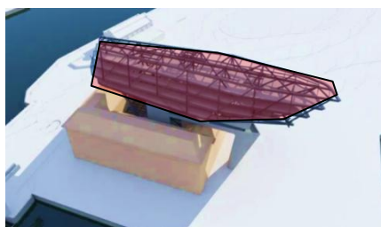
Poteau et poutre réalisé en acier.
