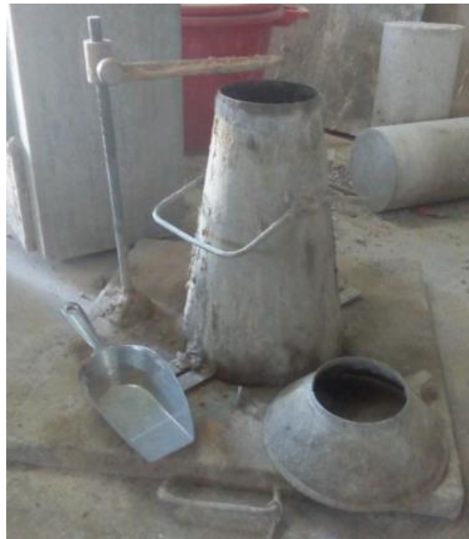
Figure III.4 : matériels nécessaire pour la réalisation de l'essai d'affaissement au cône d'Abrams
