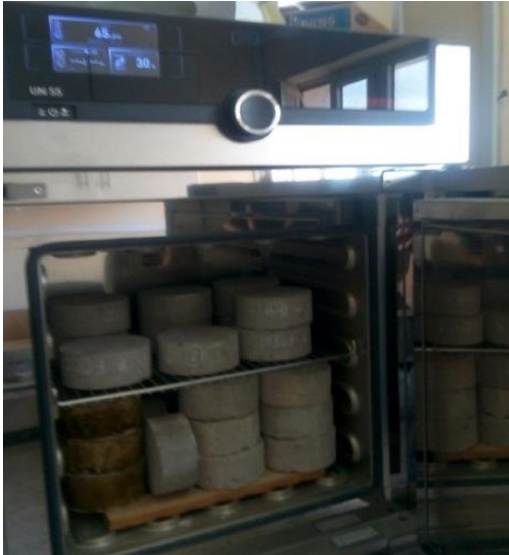
Séchage des échantillons dans l'étuve.
