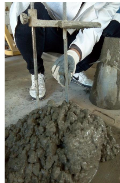
Béton avec 0,9 kg/m 3 de FPP
