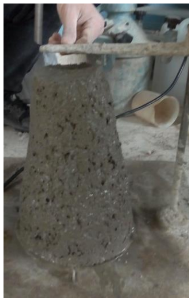
Béton avec 0,6 kg/m 3 de FPP
