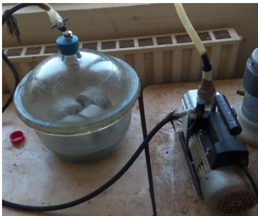
Saturation des échantillons sous vide.
