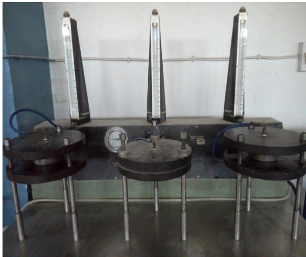
Figure III.12 : Essai de perméabilité à l'eau (Kamèche Z., 2015)
