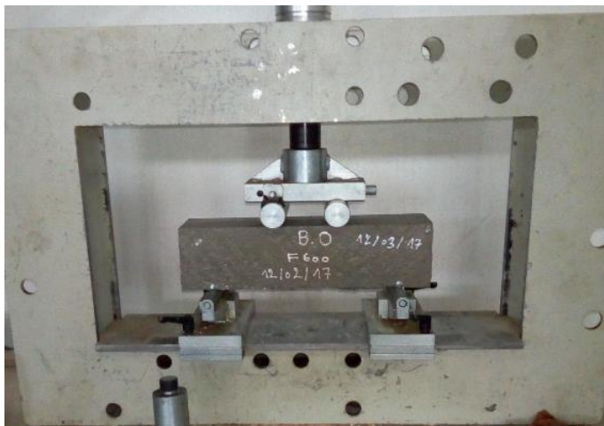
Figure III.7 : Essais de traction par flexion
