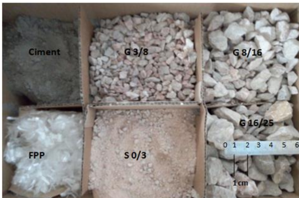
Figure III.1 : Photos sur les matériaux utilisés dans la préparation de nos bétons.
