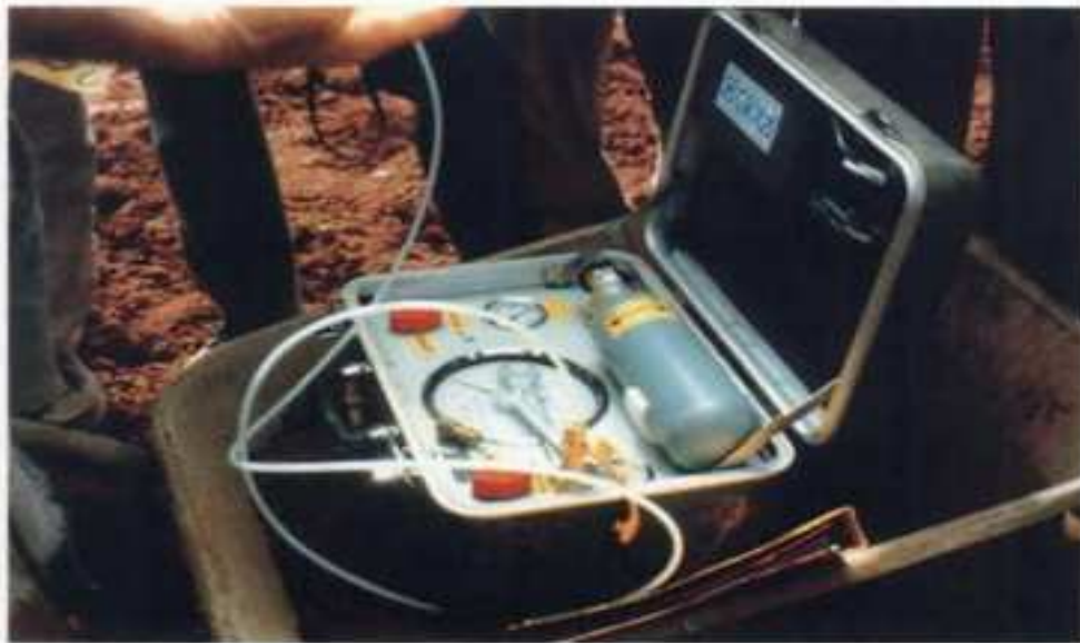
Figure 4.2 : Boitier de mesure portable pour cellule à contre pression (Royet et al, 1999)
