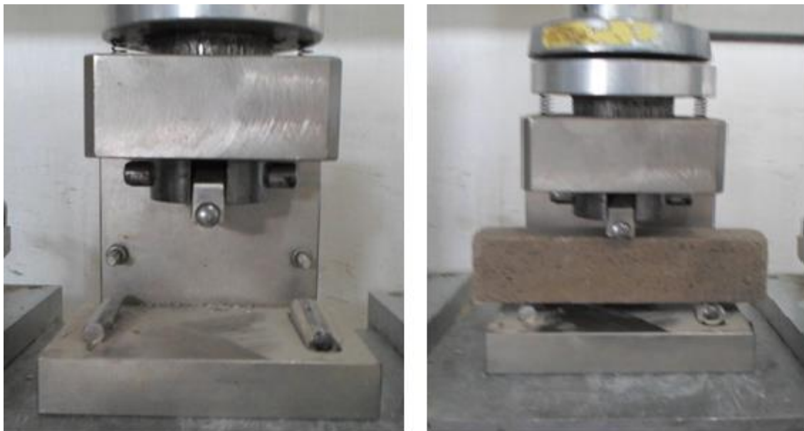
Figure 3.13: Dispositif de l'essai de flexion 3 points et les éprouvettes de mortier 4×4×16 (photos prises par les auteurs).
