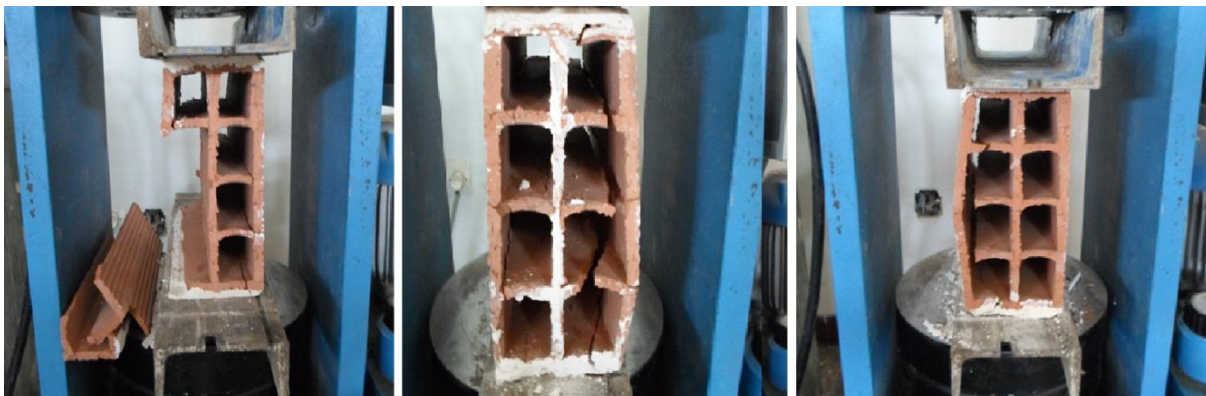
Figure 3.7 : Essai de compression des briques creuses (Photos prises par les auteurs).
