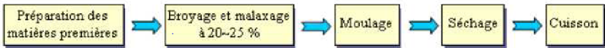
Figure 1.2: Fabrication de la brique en terre cuite (BAUD, 1990) cité par [HAMZA CHERIF et KARA ALI 2014]
