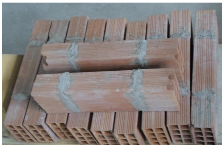
Figure 3.31: Cure et stockage des triplets prêts au cisaillement (photo prise par les auteurs).
