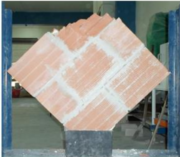
Figure 4.5: Eclatement de l'appui supérieur.
