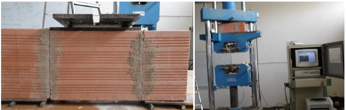
Figure 3.32: Essai de cisaillement d'un triplet (photo prise par les auteurs).
