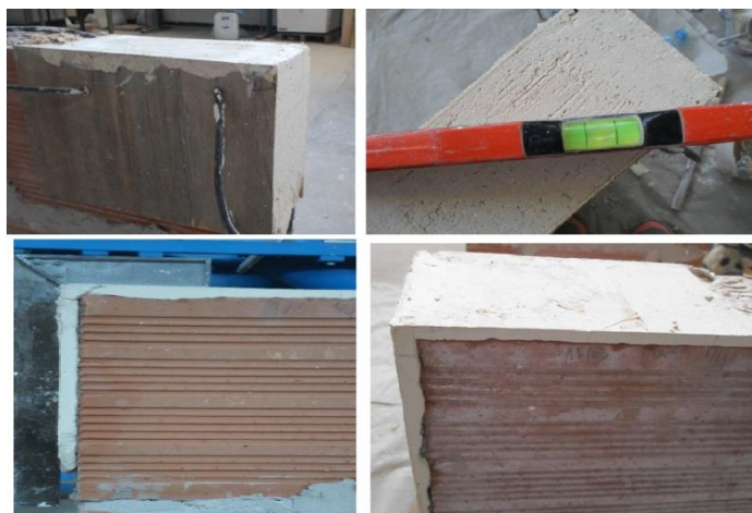
Figure 3.27: Surfaçage des deux coins du muret de cisaillement avec du plâtre pour caler correctement le faitage du muret lors de l'essai (photos prises par les auteurs).
