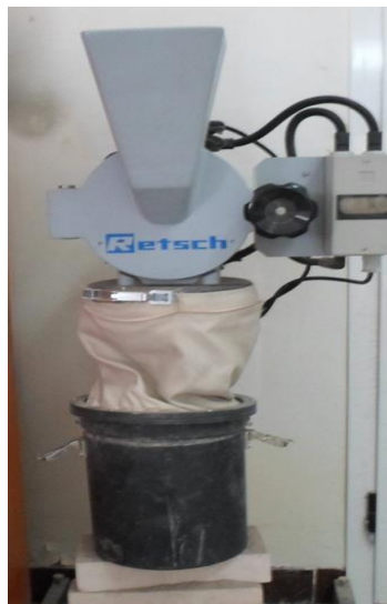
Figure 3.11: Broyeur utilisé (photo prise par les auteurs).
