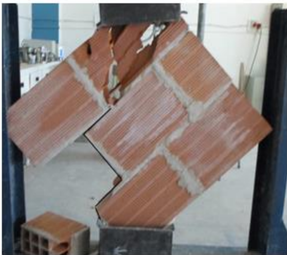
Figure 4.7 : Rupture en dents de scie.
