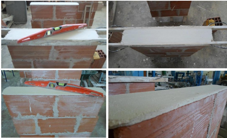
Figure 3.28: Surfaçage des murets soumis à la compression (photos prises par les auteurs).
