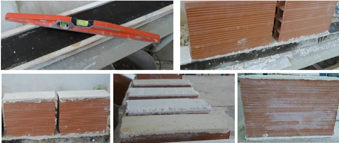
Figure 3.6 : Surfaçage des briques (Photos prises par les auteurs).
