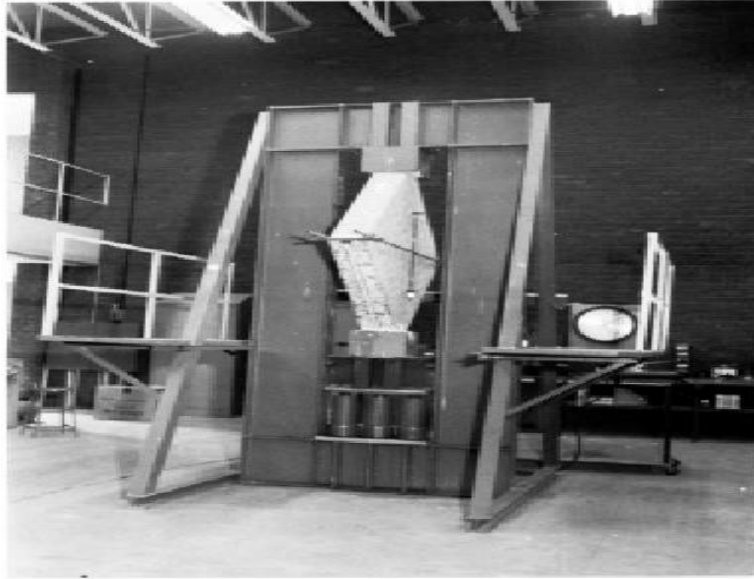
Figure 2.26: appareillage permettant de déterminer la contrainte de compression diagonal pour les murs en maçonnerie [ASTM E 519-02]
