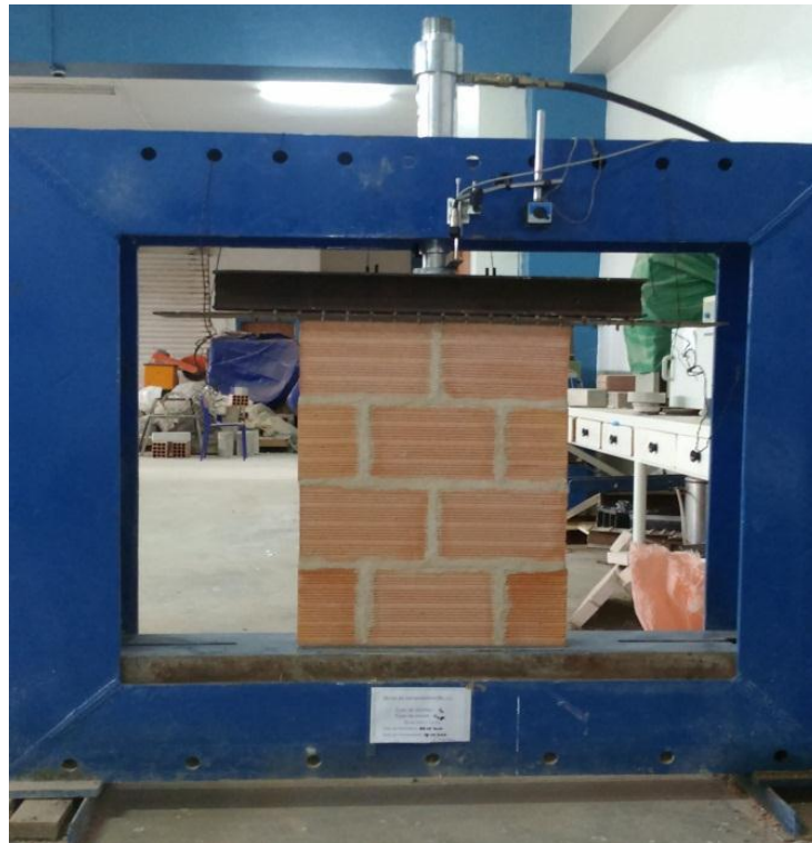
Figure 3.30: Essai de compression des murets (photo prise par les auteurs).
