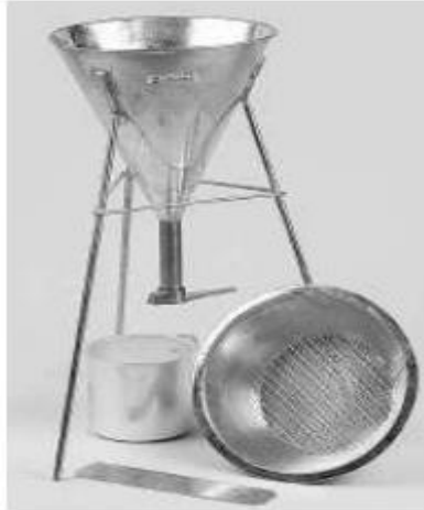
Figure 3.10: Dispositif permettant la mesure de la masse volumique apparente du liant.
