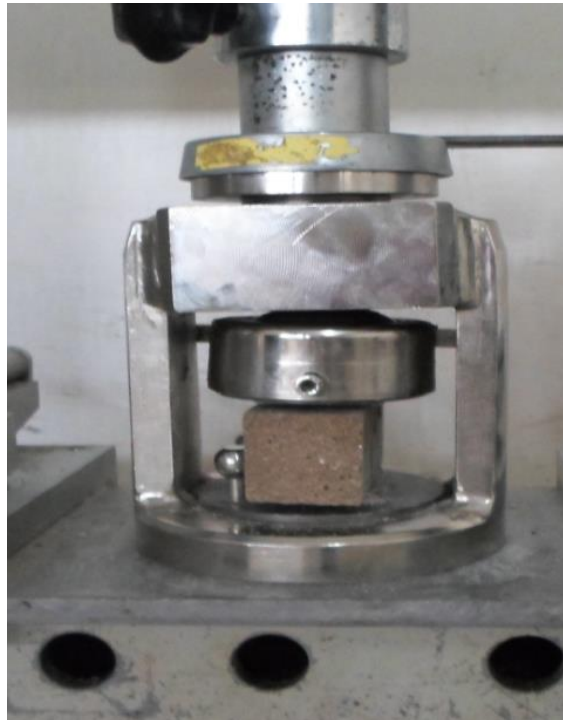
Figure 3.14: Dispositif pour l'essai de résistance à la compression (photo prise par les auteurs).
