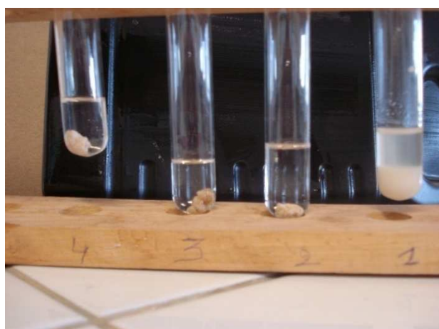
Figure IV.3 : Quatre tubes contentent du HB ester dans les solvants : eau, heptane, chloroforme et l'éthanol
