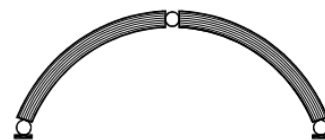
Figure 28. L'arc de cercle à inertie constante
