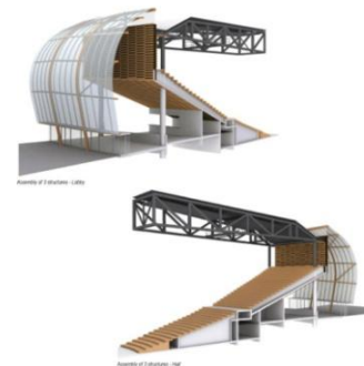
Figure 57. La structure suspendue de la salle spectacle
