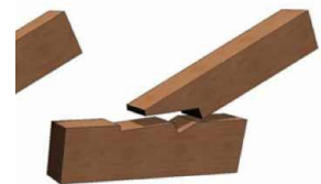
Figure 31. assemblage par contact
