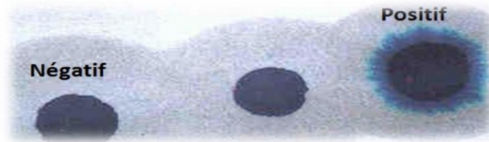
Figure 15: vérification par tache d'essai de valeur au bleu de méthylène (Cité par : ROBERT ; 2011-2012)
