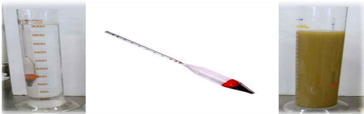
Figure 9: Appareillage pour l'essai de sédimentométrie (Cité par : MEBARKI ; 2008)
