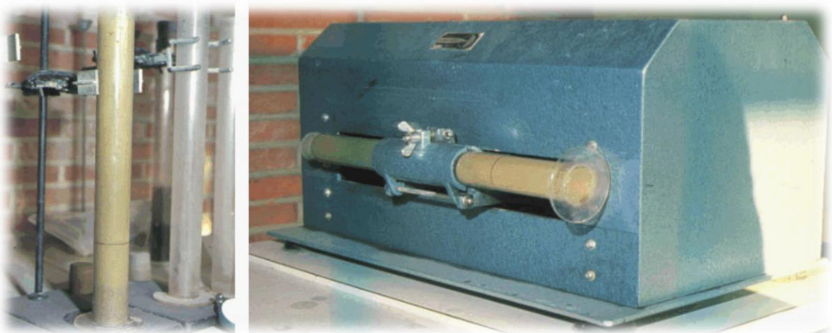
Figure 16 : L'appareil de réalisation d'équivalent de sable (Cité par : PORTET et NOË ; 2011)
