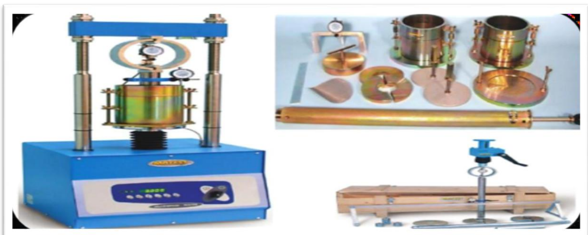
Figure 30 : Les appareils pour essai CBR (Cité par : MEBARKI ; 2008)
