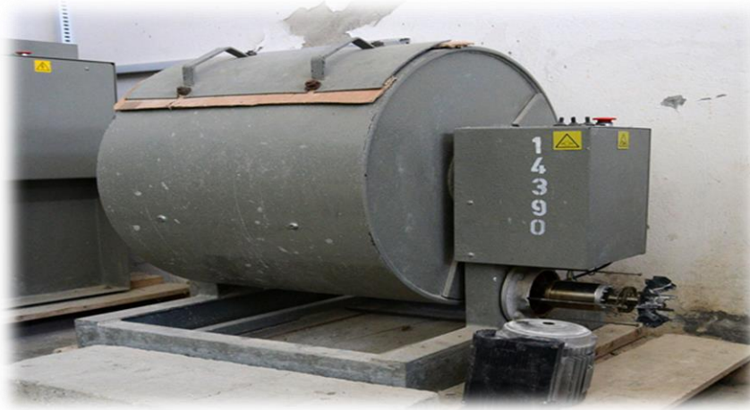
Figure 21 : La machine de Los Angeles (Cité par : PORTET et NOË ; 2011)
