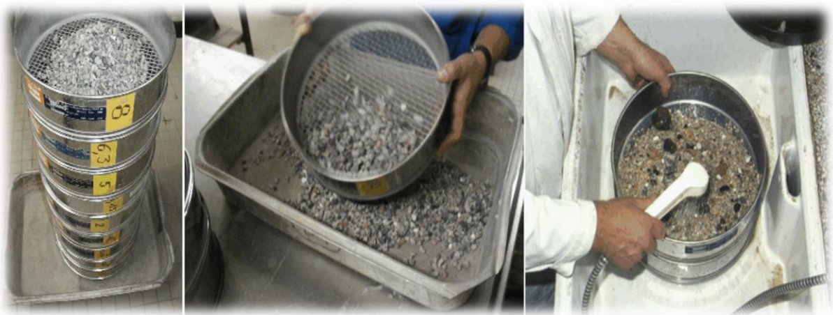
Figure 5 : Méthode d'exécution d'essai analyse granulométrie (Cité par : MEBARKI ; 2008)
