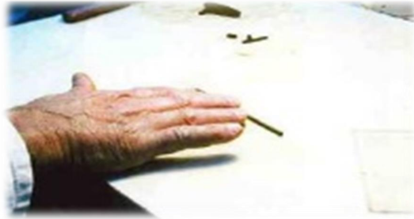
Figure 11 : Essai de limite de plasticité (Cité par : ROBERT ; 2011-2012)
