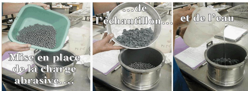
Figure 23 : Mise en place par essais Micro-Deval (Cité par : PORTET ET NOË ; 2011)
