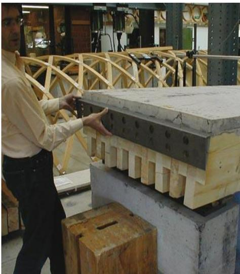
Figure 127: Plancher mixte bois/béton
