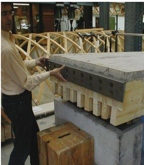
Figure 127: Plancher mixte bois/béton
