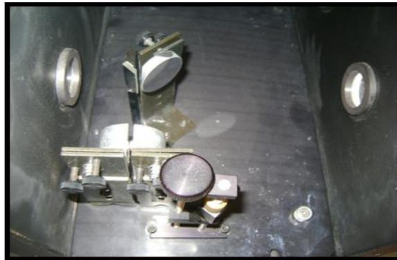
**Figure 2.5.** photo du système utilisant la réflexion diffuse
