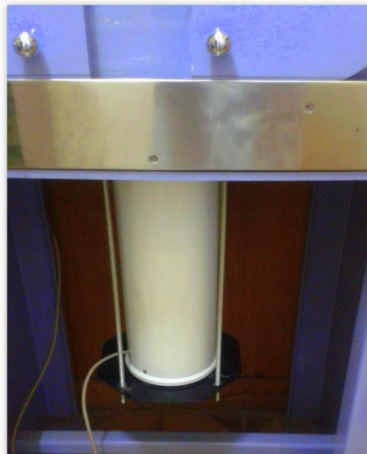
Figure 43: Comptage de la radioactivité des ITLC à l'Activimètre MEDI-404
