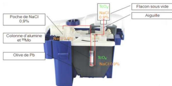
Figure 15 : Schéma du principe d'un générateur ^{99}\text{Mo}/^{99\text{m}}\text{Tc}
