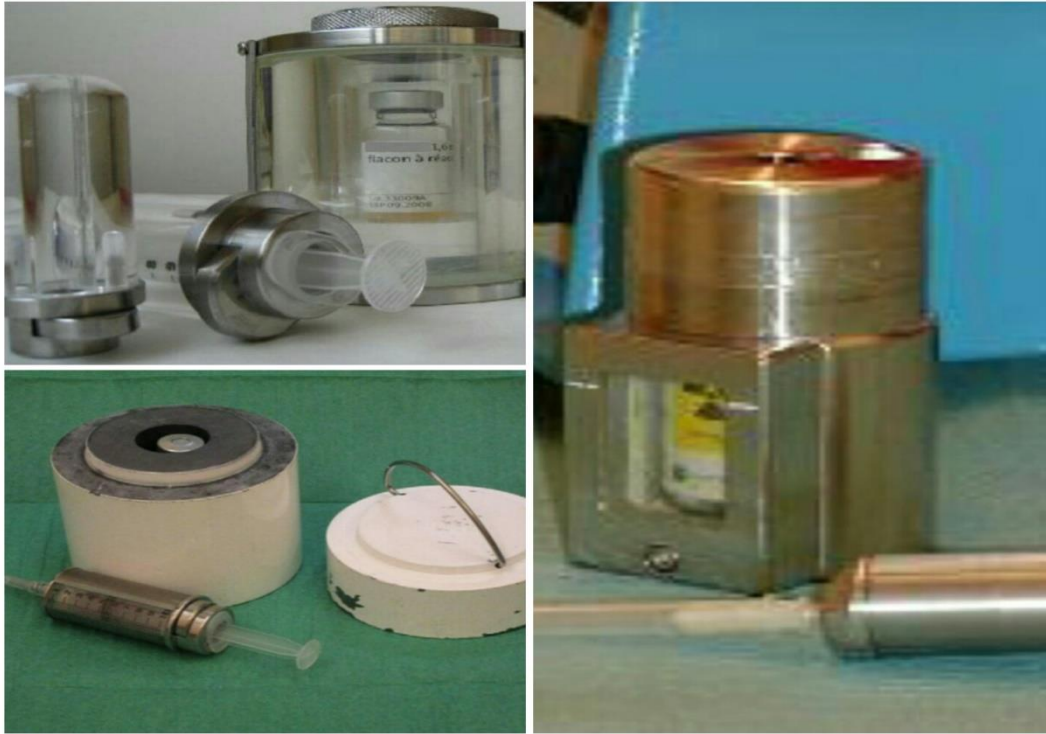
Figure 23 : Protège-seringues et protège-flacons adaptés aux énergies des émetteurs
