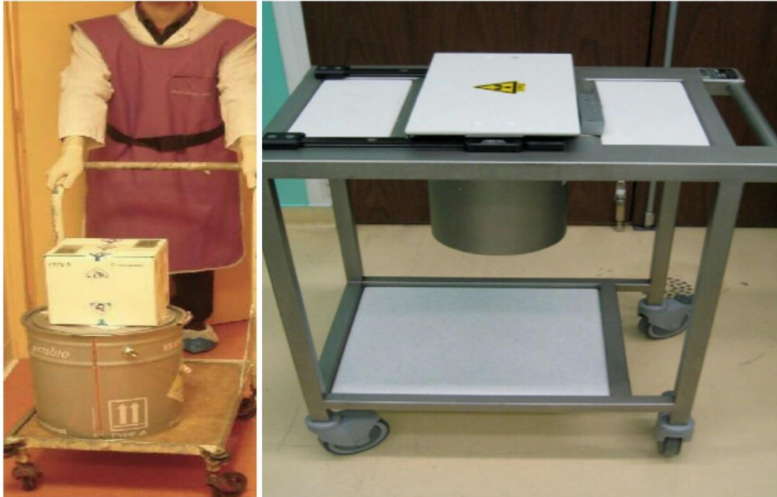
Figure 22 : Chariot de transport et un opérateur vêtu d'un tablier plombé réceptionnant un générateur
