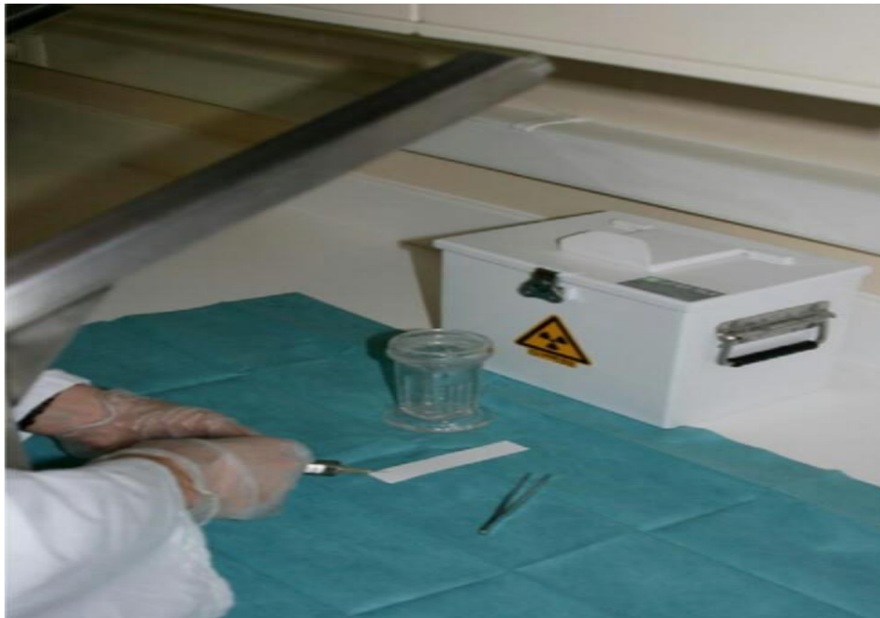
Figure 25 : Opérateur contrôlant la pureté radiochimique d'un PRP derrière un écran blindé
