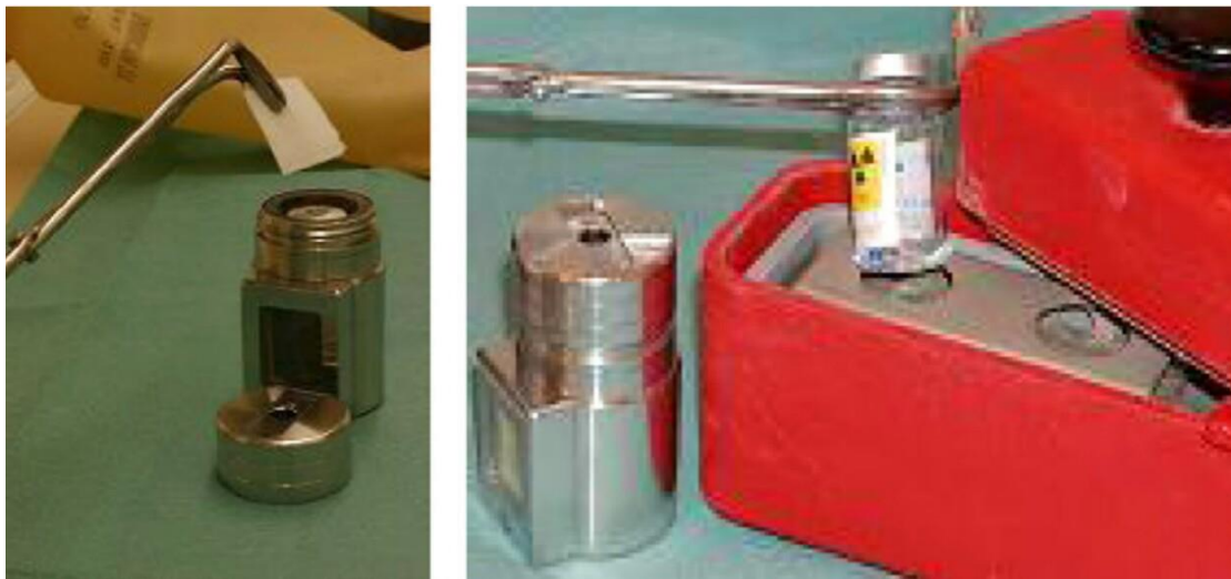
Figure 24 : Utilisation d'une pince de manipulation à distance
