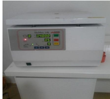
Figure 27 : Centrifugeuse
