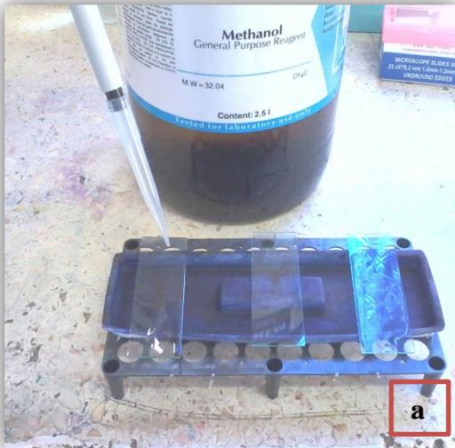
a: Fixation des frottis par le méthanol.
