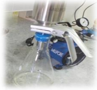
Rampe de filtration
