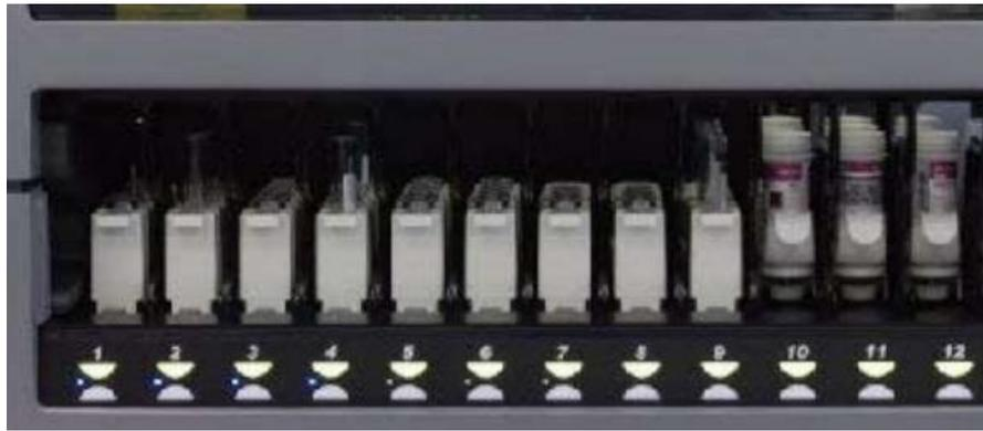
Figure 29: Emplacement des portoirs échantillons dans l'automate.
