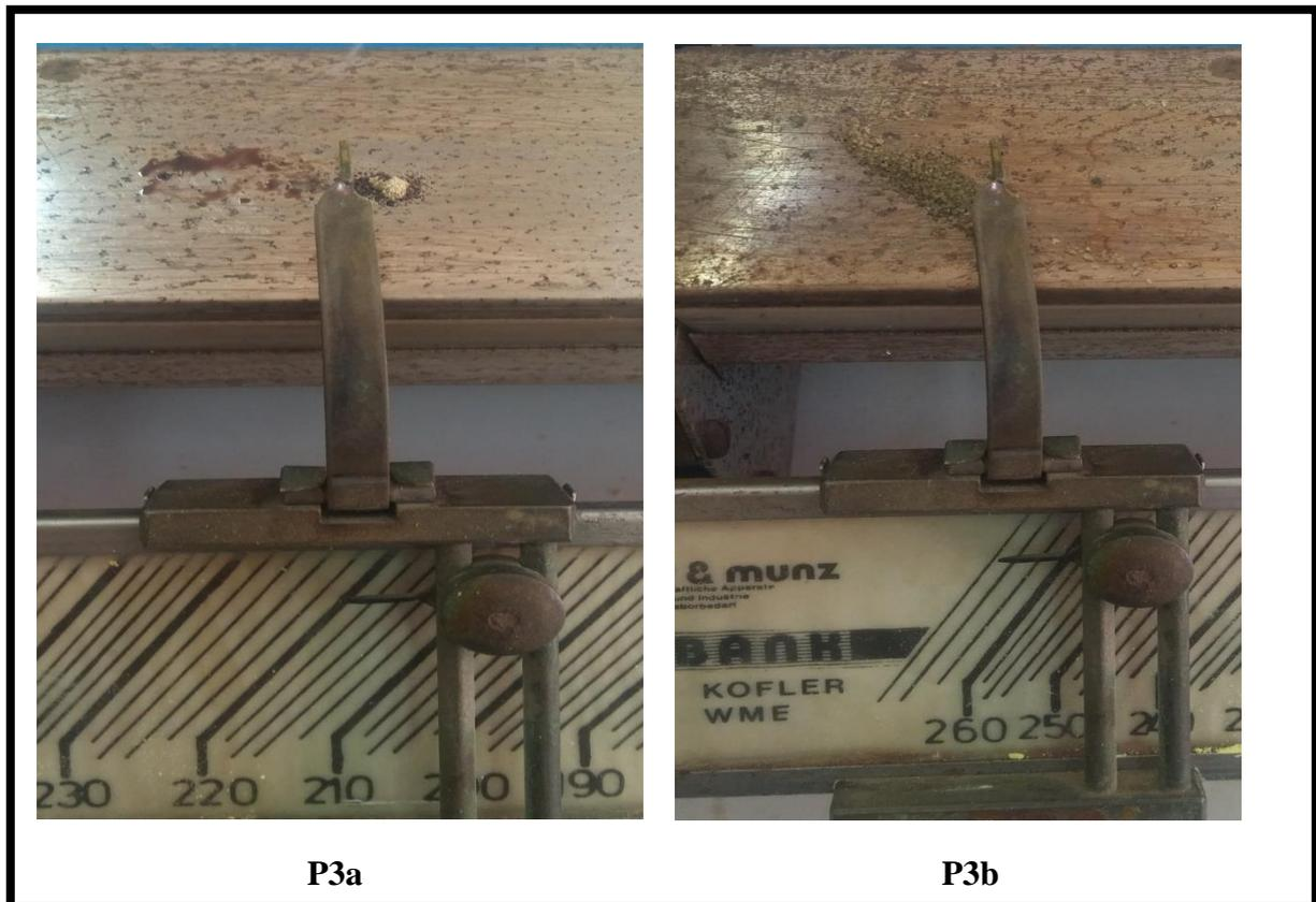
**Figure 56: Point de fusion comparatif du P3a et P3b au banc Kofler**
