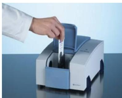
**Introduire la pastille dans le spectrophotomètre**
