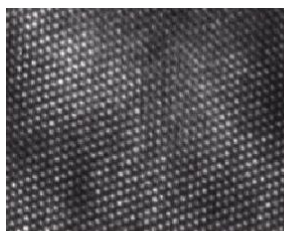
Fig. I-1 : Micrographie du réseau cristallin du silicium prise par TEM. [14]
