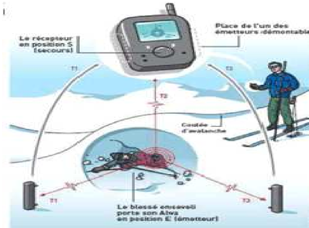
Figure I. 15 : Détection de personnes ensevelie sous la neige par le système ALVA.
