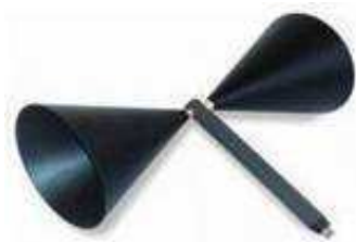
Figure II. 10: Réalisation pratique de l'antenne biconique finie.
