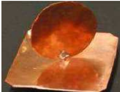
Figure II. 12: Exemple de réalisation pratique d'un monopole circulaire (rayon 2.5 cm).
