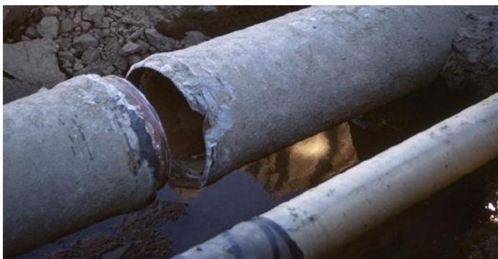
Figure 2-14 : Ecartement des conduites au niveau du raccordement San Fernando, 1971
